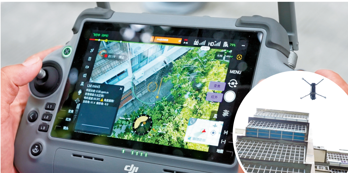
工作人员用无人机检测甲烷泄漏情况。（王佳辉 刘雨 摄）
