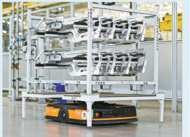
“5G+AGV”在转运汽车零部件。
