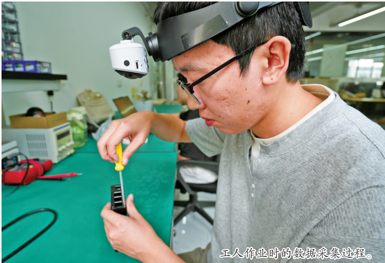
工人作业时的数据采集过程。
