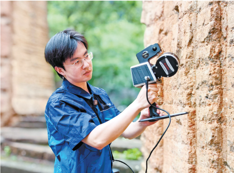
黄凝用三维激光扫描仪扫描安远炮台。（沈孙晖 张超梁 摄）
