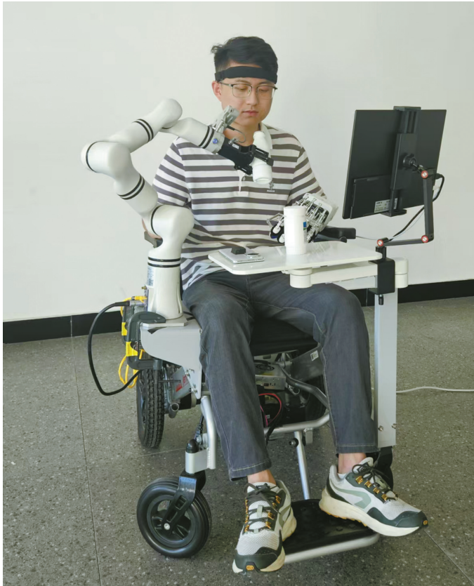
团队成员在调试自主研发的脑机接口康复设备。
