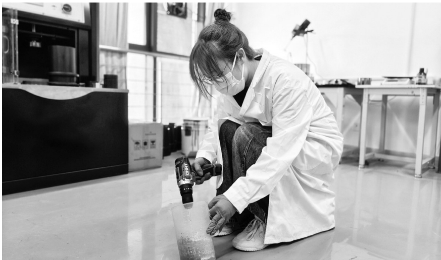
方楠在调制低碳混凝土。
