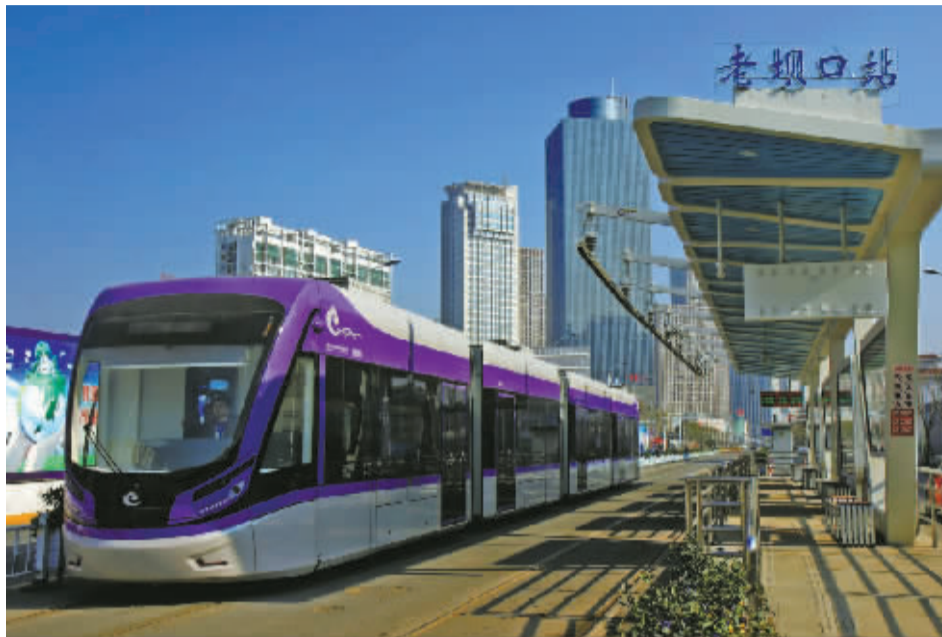
装载超级电容器的有轨电车。
