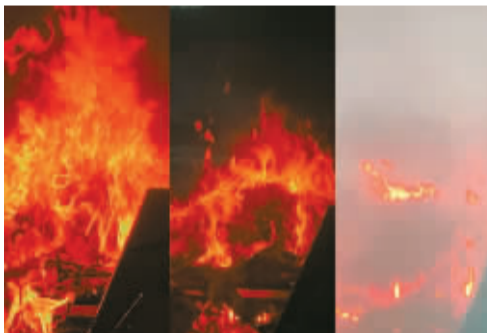
实验中，一号房间起火后，喷淋启动出水，10秒内火势从大至小动态图。
