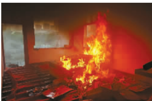
实验中，无喷淋保护的二号房间，起火后火势越来越大。
