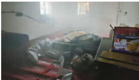
实验中的一号房间，喷淋灭火后，现场过火面积仅1平方米。
