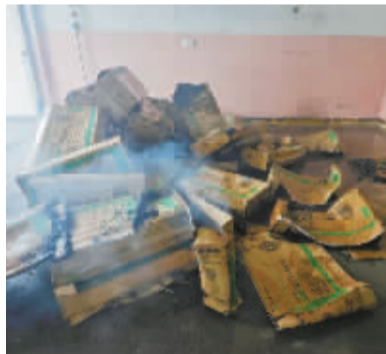
模拟的厂房堆垛起火后，喷淋启动出水扑灭明火。
