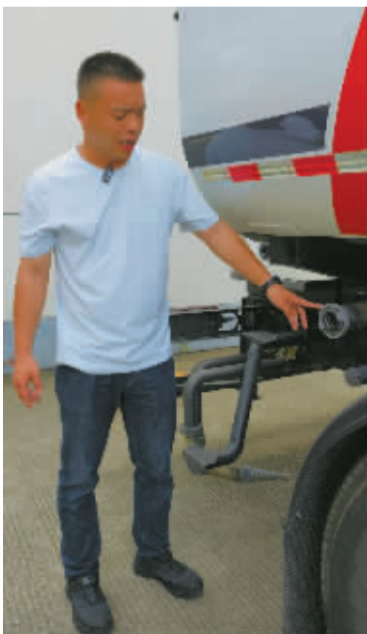
改造后的洒水车出水阀口。
