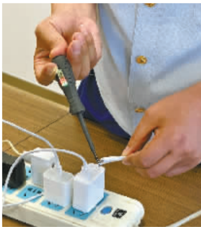
▲消防部门开展空载充电头温度对比测试。
