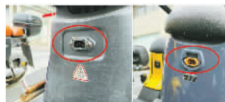
保护盖脱落后,裸露的充电口。
