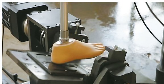
谱麦科技的人形机器人全步态模拟及耐久性试验。 据谱麦科技视频号
