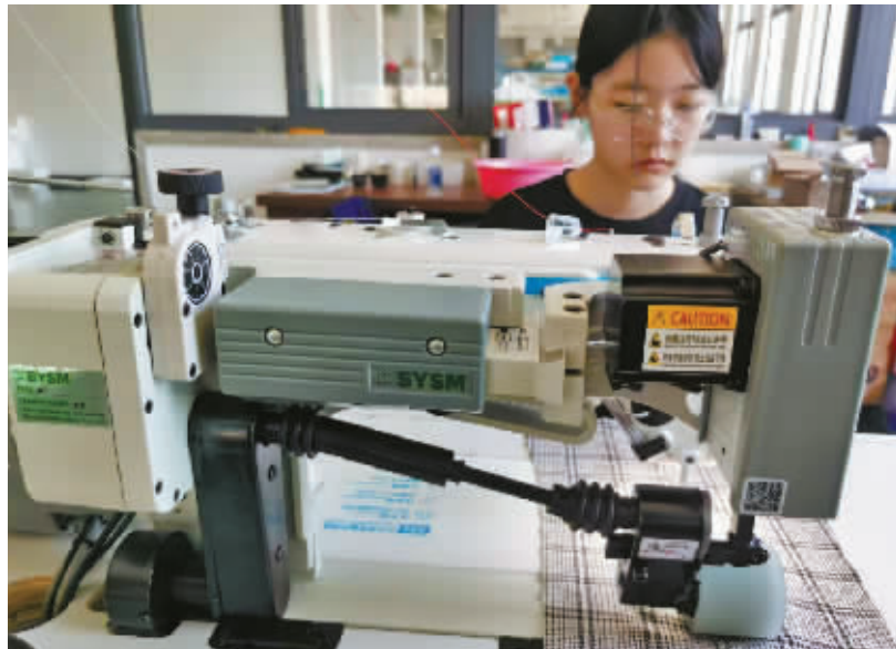
配备了“智能缝纫机助力与布料推进系统”的缝纫机。
