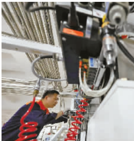
技术人员正在调试他们自行研制的大型设备。通过锁边改进技术，该设备生产出来的超薄膜厚度仅0.005毫米。
