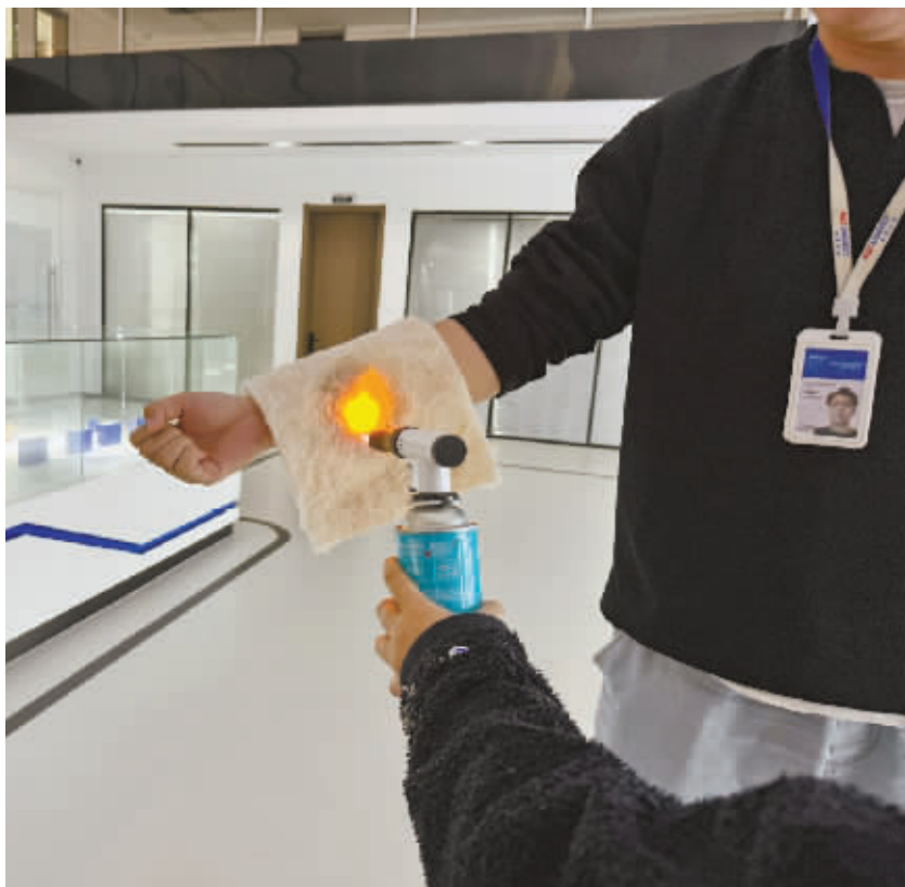
这种纳米纤维织成的陶瓷材料能抗住1300℃的高温。
