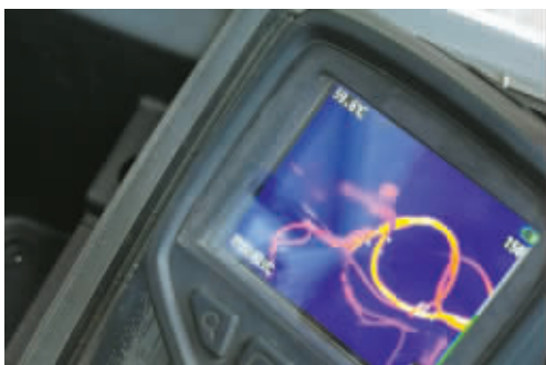
加大电机功率后，5分钟内线束温度已达近60℃
