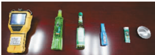
实验准备：测温计、花露水、打火机、耐火试验盘。
