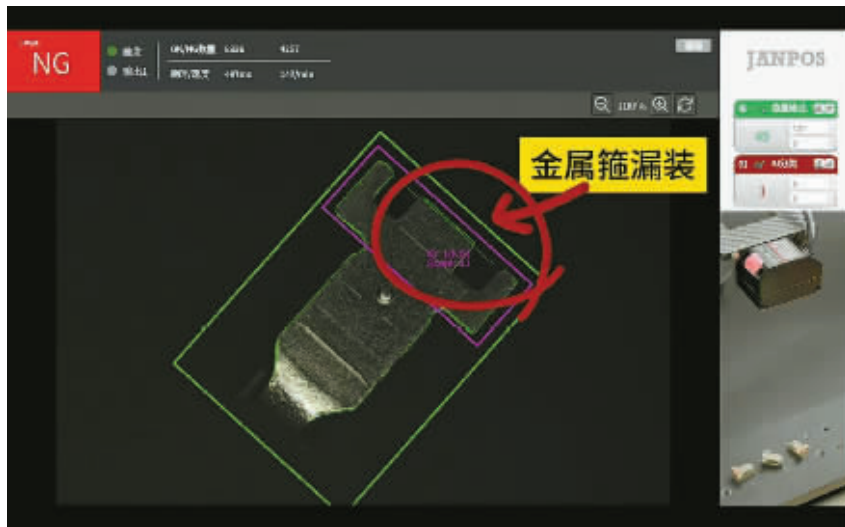
工业AI智能相机能精准识别产品的瑕疵。
