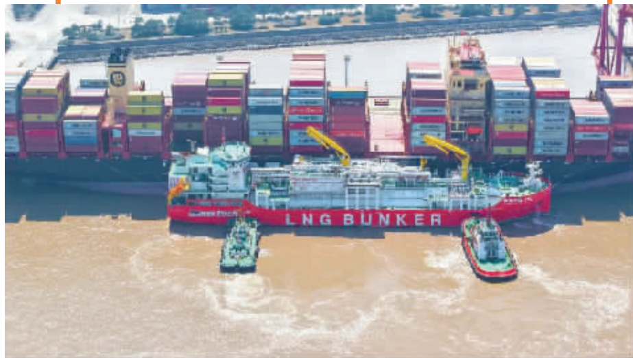
加注船为大型集装箱船加注LNG。通讯员供图
