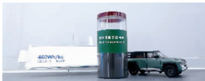
富锂锰基正极材料及基于富锂锰基正极和硅碳负极的高比能锂离子电池。 受访者供图
