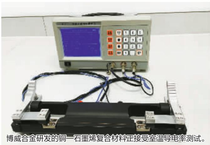
博威合金研发的铜—石墨烯复合材料正接受室温导电率测试。
