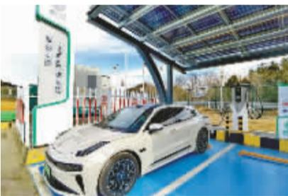
新能源车主正在使用站内的“Chaoji”液冷充电终端充电。记者 黎莉 摄
