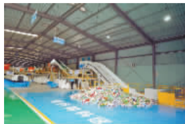
海曙区可回收物分拣中心混合塑料分拣线。
