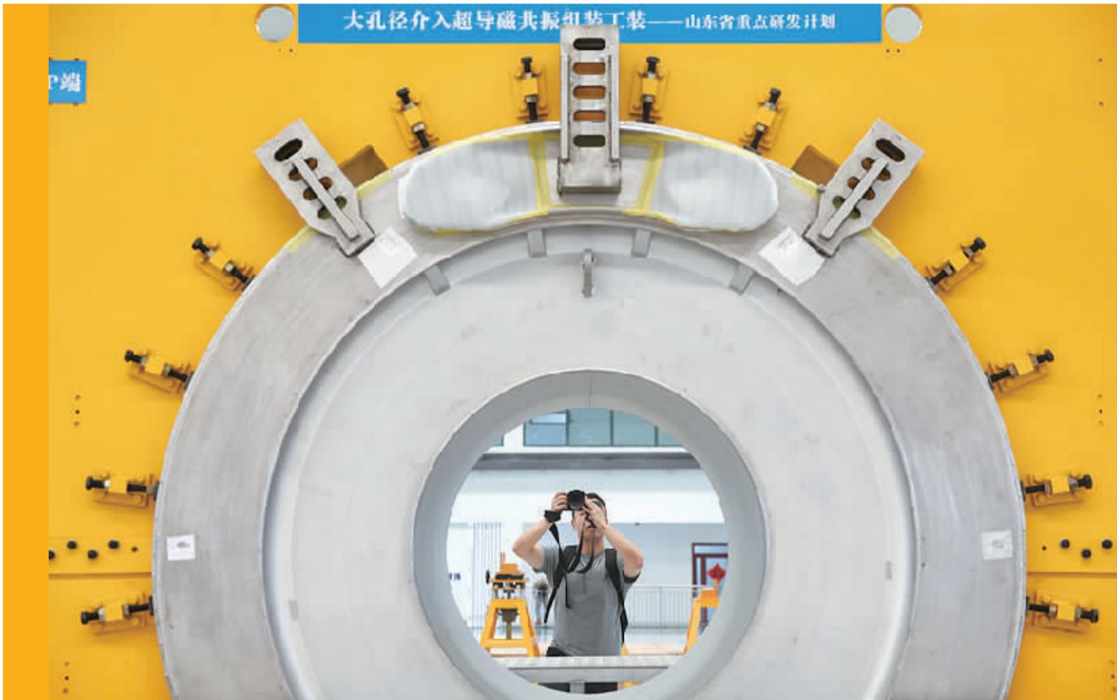
大孔径介入超导磁共振组装工装——山东省重点研发计划
