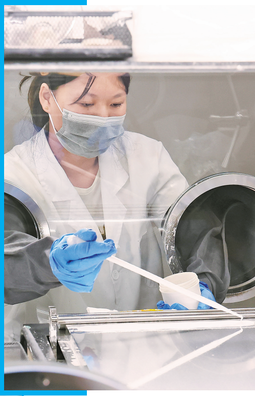
在位于宁波前湾新区的浙江省绿色智能汽车及零部件技术创新中心实验室内，科研人员正在开展固态电池原型电芯制备与工艺验证。
