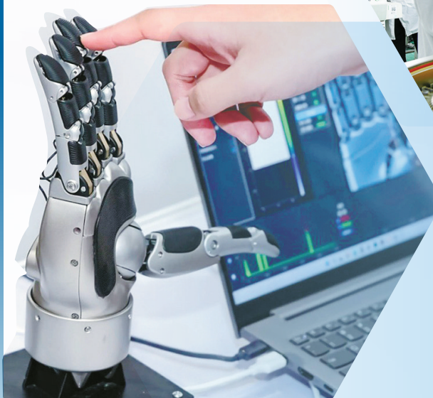
▲圆芯电子的人形机器人指腹传感器应用。
