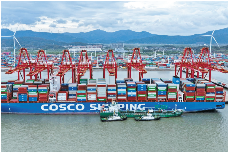
专业甲醇加注船“中燃绿能85”轮对集装箱船“中远海运天祥”轮进行绿色甲醇燃料加注作业。（杨江琦 摄）
