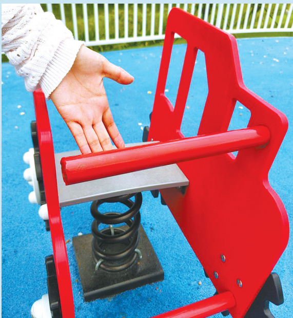
永平公园一处摇摇车横向扶手一侧脱落。（杨绪忠 摄）
