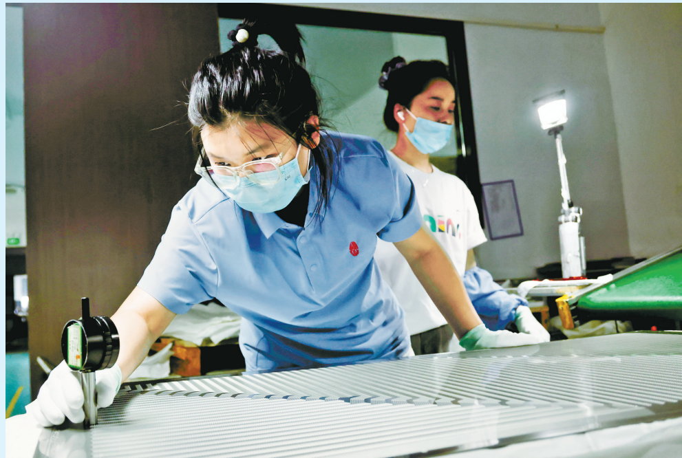
随着AI大模型训练需求激增，单芯片功耗突破千瓦级，散热已成算力竞赛的“瓶颈”。位于北仑芯港小镇的福至新材料，利用半导体精密蚀刻工艺抢占AI液冷散热赛道——在巴掌大的金属冷板上，藏着百米长的微细流道，冷却液蜿蜒穿行，为芯片悄然降温。图为工作人员正在检查大型散热片。 (许天长 叶晶晶 邹欣欣 摄)
