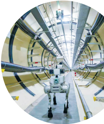
四足机器人在电缆隧道内自主开展线路巡视和带电检测。
