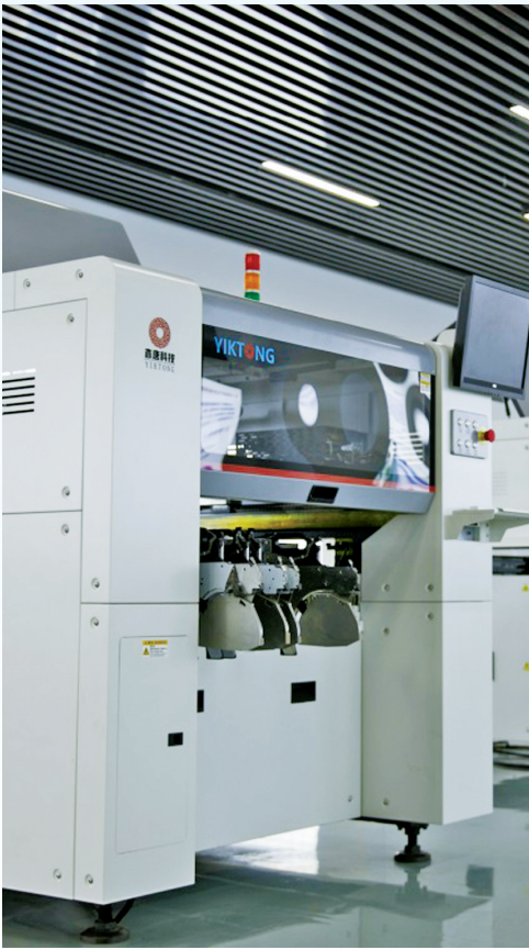
亦唐科技生产的高速高精度贴片机。 (赵煜 摄)
