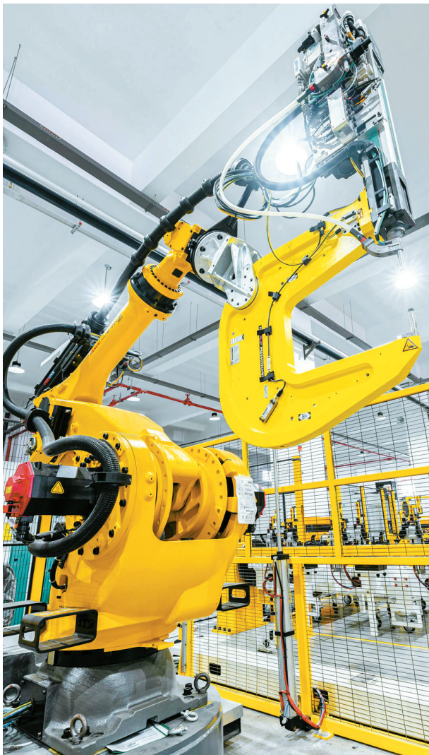
旭升集团装配车间SPR自冲式铆接设备。
