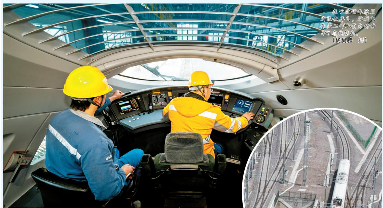
在宁波动车运用所检修库内，杭州动车段工作人员分析动车组车载信息。（杨昊 摄）
