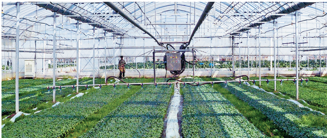
在大棚里作业的自走式喷灌机。
