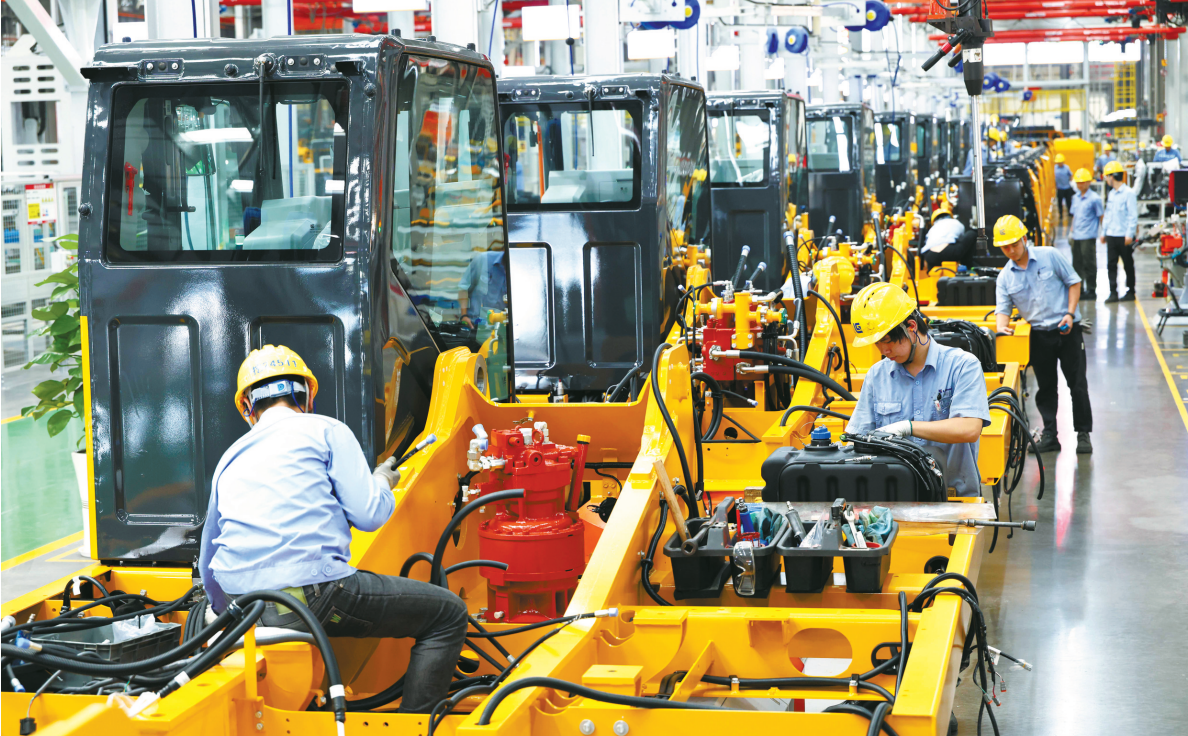
这是在广西柳州市柳工挖掘机智慧工厂拍摄的挖掘机上部机构件组装线（2024年11月12日摄）。（新华社记者 金皓原 摄）
