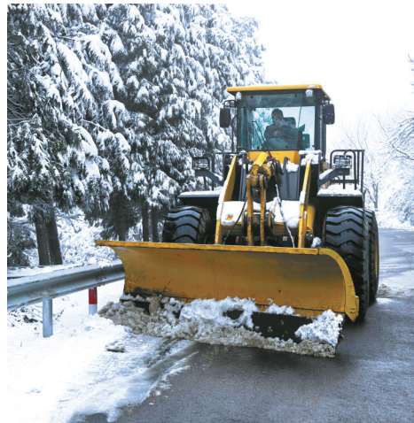
▲铲雪、扫雪、融雪……昨日上午，在奉化线四明山镇屏山村段，10余名来自余姚市舜杨公路养护有限公司的抢险队员驾驶除雪车辆通力配合，高效清理主干道积雪。针对陡坡、急弯等危险路段，养护工人还撒布了融雪剂，确保行车安全。(顾佳诚 陆燕娜 摄)
