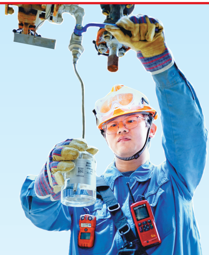
生物航煤装置外操人员正在采样。
