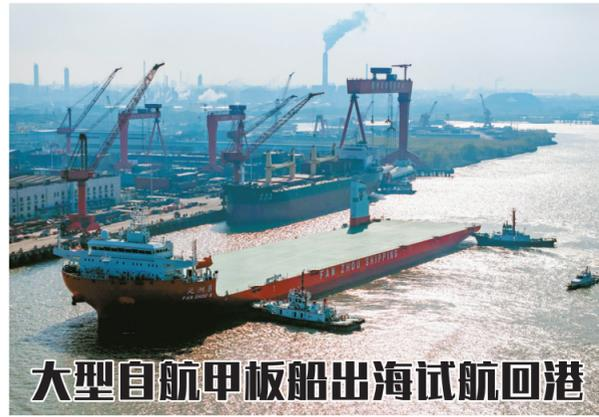
2月22日,“泛洲8”轮准备靠泊在泰州众船厂舢板码头(无人机照片)。当日,在海事部门全程协调维护下,大型自航甲板船“泛洲8”轮从上海以东水域进行为期5天的各种专业航海测试后回港。“泛洲8”轮总长256米,型宽51米,型深13米,最大载重量58405.4吨,续航可达16000海里,最大航速超过15节(约27.78公里/小时)。该船适航能力强,满足极地规则要求,可航行于小冰漂流冰海域。
