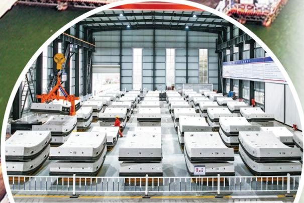
中铁十四局甬舟铁路项目建立了盾构行业首个智能配送中心,面积3300平方米,采用工厂化管理模式,通过遥控器控制AGV智能小车,将管片自动转运到施工现场。(沈莉 宋新宇 摄)
