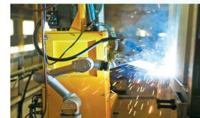
智昌科技研发的中集波纹板焊接机器人。（受访者供图）
