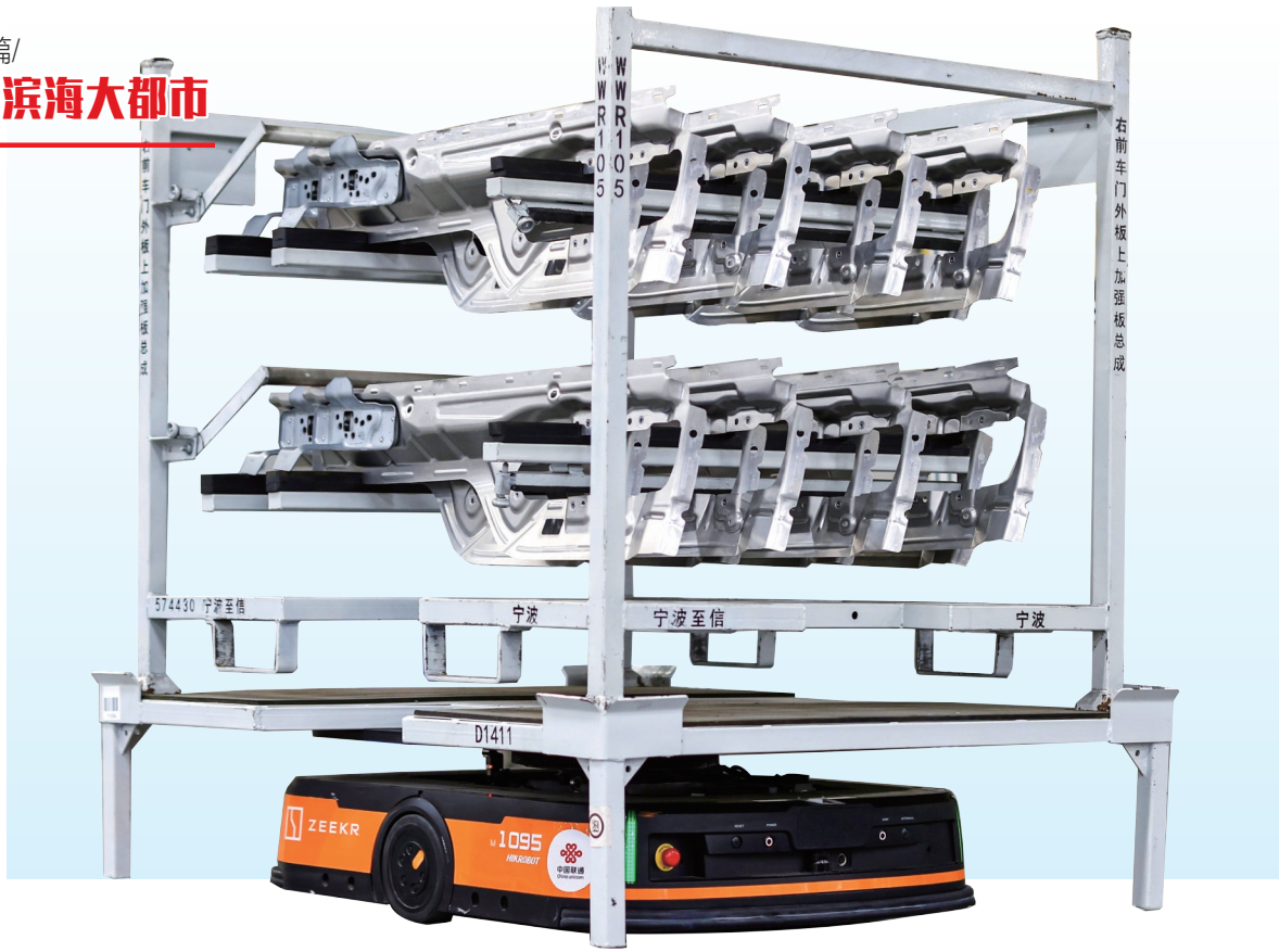
在极氪汽车的生产基地内，“5G+AGV（自动导向车）”已成为搬运主力。
