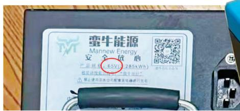
外卖骑手从换电柜中取出的电压为65伏的电动自行车超标电池。
