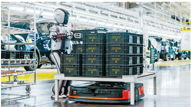
人形机器人与AGV配合完成物料的搬运。(受访者供图)
