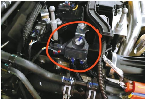
红圈处印出故障的压力传感器。
