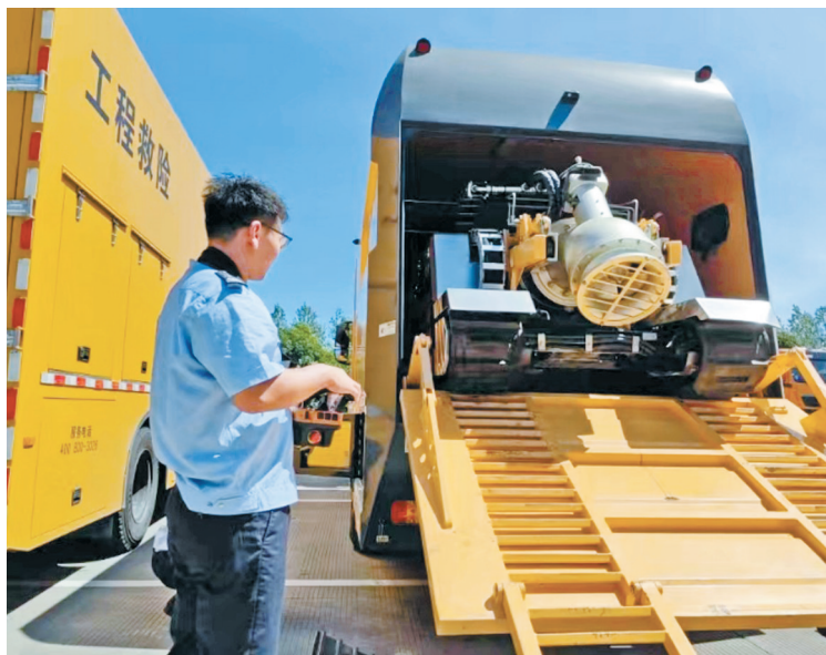
浙江省交通集团高速公路宁波管理中心对杭甬高速宁波段、甬台温高速宁波段二期、杭甬高速复线宁波段一期展开防台防汛保障工作，23日以来，已出动巡查人员120人次，巡查桥梁涵洞500余座，3台应急排水车、2台抽水泵已调试完毕。图为工作人员在检查“龙吸水”应急排水抢险车的运行状态。（林昱辰 王雨晨 摄）
